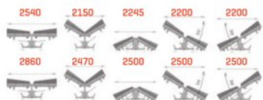
Схема работы снегоотвалов PDZ 24 и PDZ 28
