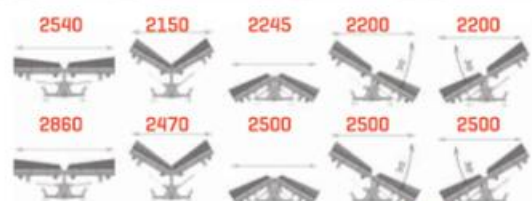
Schéma de travail de chasse-neige PDZ 24 et PDZ 28
